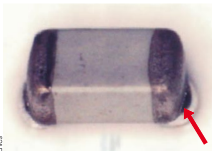
Bild 1 Löttest an 6 Jahre altem Bauelement.
